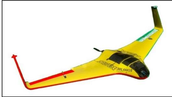
FIGURA 2. AERONAVE REMOTAMENTE PILOTADA - RPA, MODELO ECHAR 20 A, UTILIZADA PARA O MAPEAMENTO. (Fonte: Xmobots).
