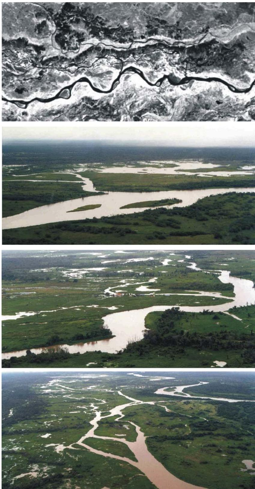
Figura 76 – Fenômeno de avulsão do canal do Taquari na altura da fazenda Caronal: A) detalhe da figura 75-B, mostrando dois pontos de rompimento do canal; B) arrombados e novo canal em formação, vistos em fotografia aérea oblíqua obtida em fevereiro de 2000.
