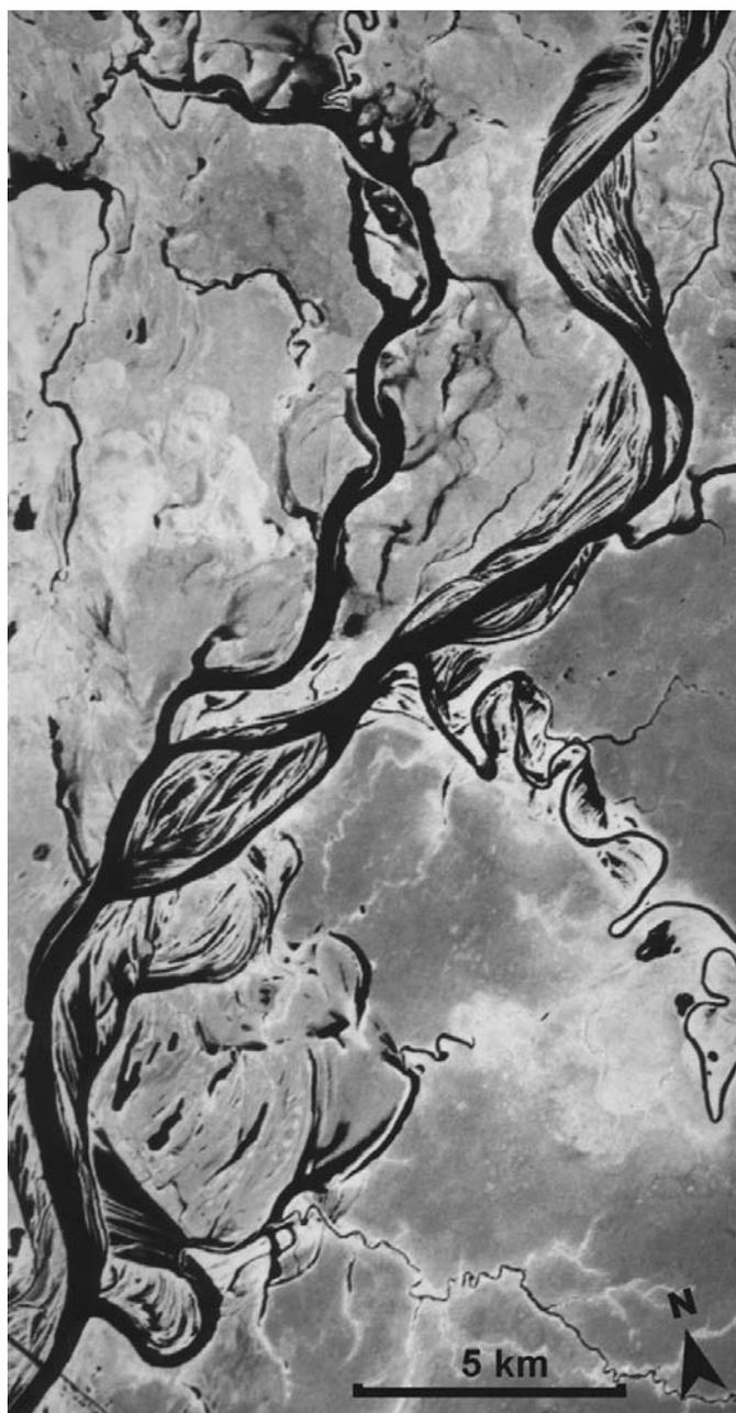
Figura 65 – Rio Paraguai, fluindo de norte para sul no Pantanal do Jacadigo-Nabileque. O canal atual é largo e retilíneo e corta meandros abandonados de menor largura, evidenciando mudança recente no padrão fluvial (imagem de satélite Landsat TM, banda 4, outubro de 1990).
